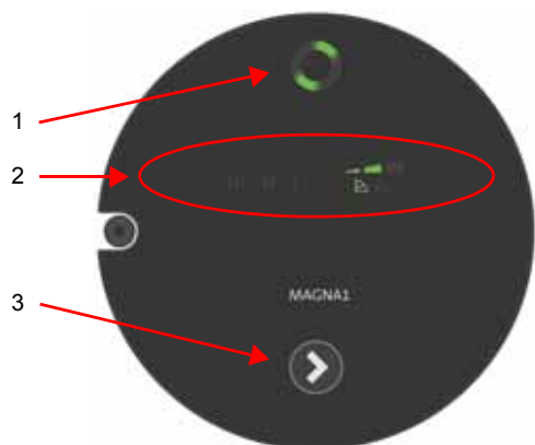
Rys. 10 Panel sterujący przy pierwszym uruchomieniu.
